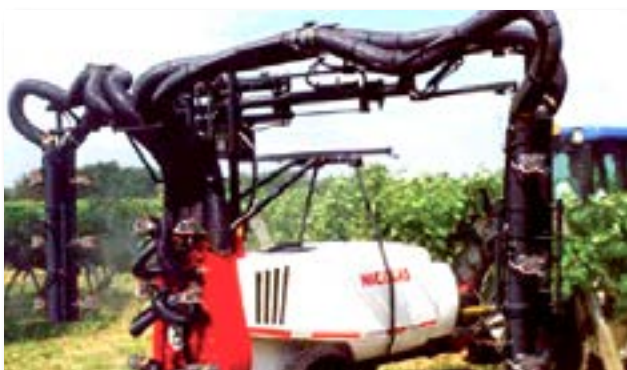
Rampe Variface est équipée de descentes avec canons
