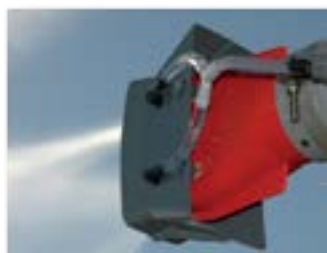
Effet Venturi avec Turbo diffuseurs et orientation électrique des canons
